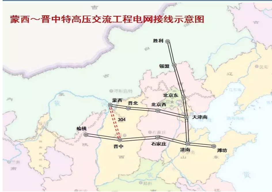
图表 98 蒙西—晋中特高压交流特高压接线示意图
